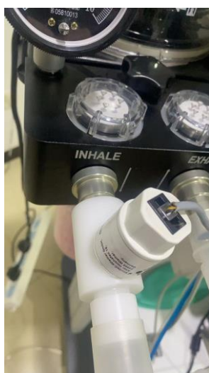
2-8 El otro extremo se conecta al puerto de inhalación de la máquina de anestesia.
