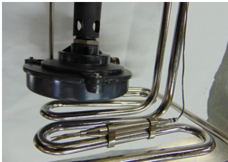
7.6a Sonde du thermostat pour des températures de travail inférieures à 120°C
