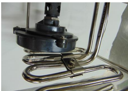
7.6b Bulbe du thermostat pour les travaux à des températures supérieures à 120°C
