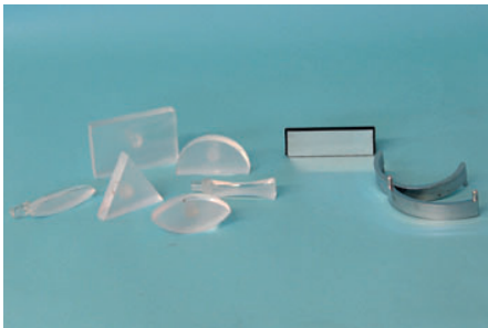
Détail jeu de prismes acryliques, lentilles et miroirs.
