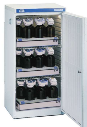
Modelo "Medilow M". Capacidad: tres bloques DBO.
