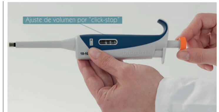
Selección del volumen mediante mecanismo “click-stop”
