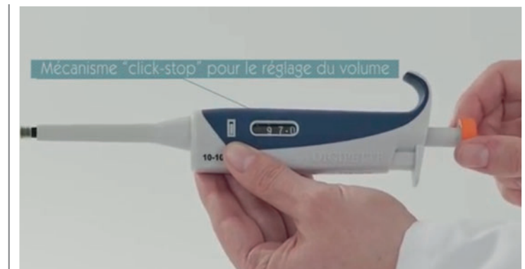
Sélection du volume au moyen d'un mécanisme «click-stop»
