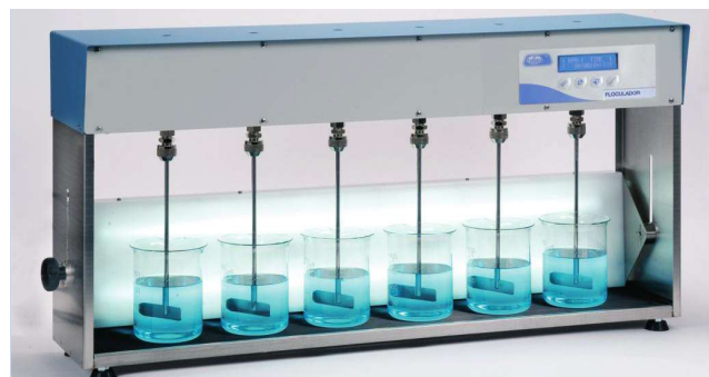
Floculateur « Flocumatic » avec éclairage en position verticale. 6 postes.
