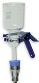
1 | Con una capacidad de 300 mL, permiten la utilización de filtros de membrana de 47 mm de diámetro.
