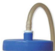
1 | Para su uso en rampa de filtración de circuito doble es necesario incorporar las correspondientes tapas de conexión en los embudos de vidrio.
