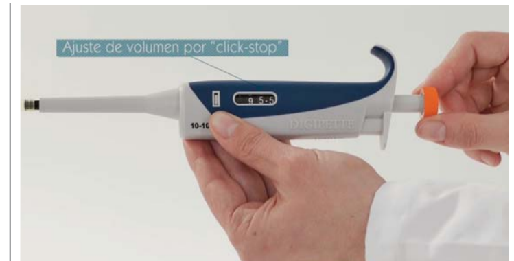
Selección del volumen mediante mecanismo “click-stop”
